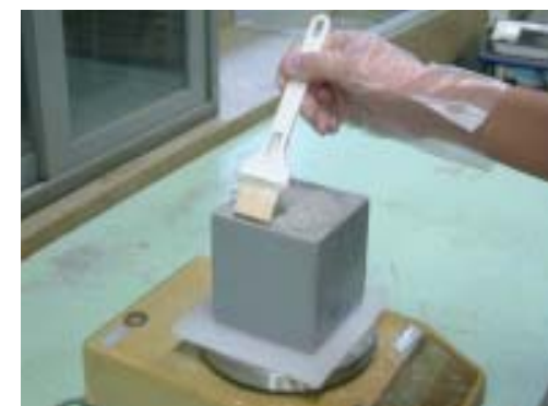
写真 - 1 含浸工程実施状況
