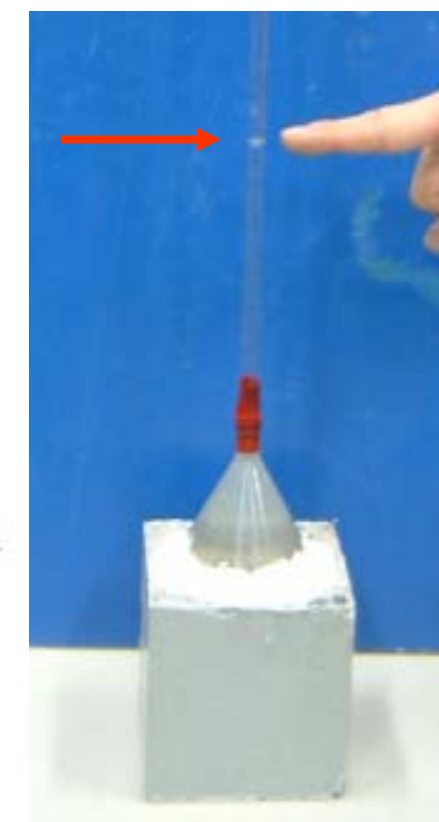
写真 - 6 透水量側定の例
