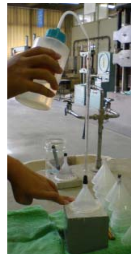
写真 - 3 透水試験実施状況
