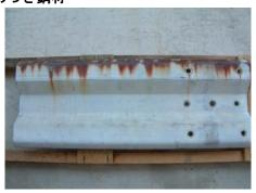
雨や紫外線のよく当たる上部より上塗り塗装が劣化し、下地のめっき層ま で腐食が進んで、鉄素地から錆汁が流 れている状態。
