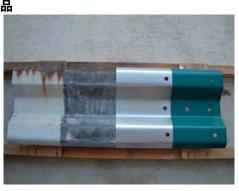
劣化した鋼構造物(亜鉛めっき製品 含)に少工程で長期に亘る高耐久性を 付与し、維持管理費およびライフサイクルコスト の低減が可能な画期的な補修システムで \*
