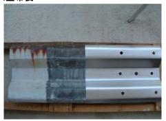
1次防錆処理として、耐食性のよいアルミを特殊加工し無機系封孔剤に高濃度分散させたセラアルミを塗付します。
